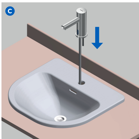
C. Introducir la conexión por el taladro de la encimera del lavabo y posicionar el grifo de forma que quede centrado sobre este. Insert the connection through the hole in the sanitary desk and position the tap so that it is centered on it.
